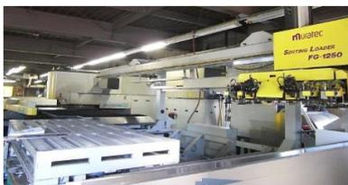
この量をバッチ式(作業者が1枚ごと機械にセットする方式)で毎日こなすには、回数・重量ともに大変な労力を強いることとなります。そこで専用の自動搬送・搬出装置(ローダー・アンローダー)を連動させることで材料の積み下ろしが1日1回に集約可能となり、負担軽減・所要時間の大幅削減が図れています。
